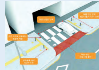
부산시 유니버설 디자인 가이드라인 (경사로 포장 설치 예시)
