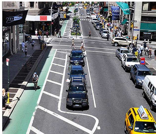
18번가에서 21번가까지의 구간은 한 차로를 줄이고 자전거 도로 옆 완충지대를 조성하였다. 이 지역은 다른 지역에 비해 차도 폭이 넓지 않아 보도 폭은 넓히지 않고, 안전하게 자전거를 이용할 수 있도록 정비하였다. 자전거 도로는 차도와 노면 표시로만 구분되어 있을 뿐 경계선에 단차를 주거나 연석을 설치하지 않았다. 하지만 완충지역이 주차공간으로 활용되고 있어, 주차된 차량이 자전거 도로 이용자를 보호하는 역할을 하고 있다. 이 지역에서는 물리적인 변화 없이 가로 단면의 이용방식만 바꾸고, 노면 표시를 정비하여 다른 지역에 비해 저렴하고 빠르게 도로 다이어트가 이루어졌다.
