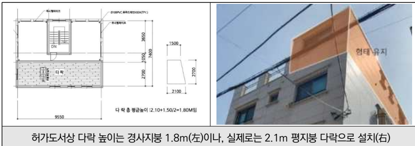
[그림 2-13] 허가도서상 다락 높이를 초과하여 위반건축물로 적발된 사례
