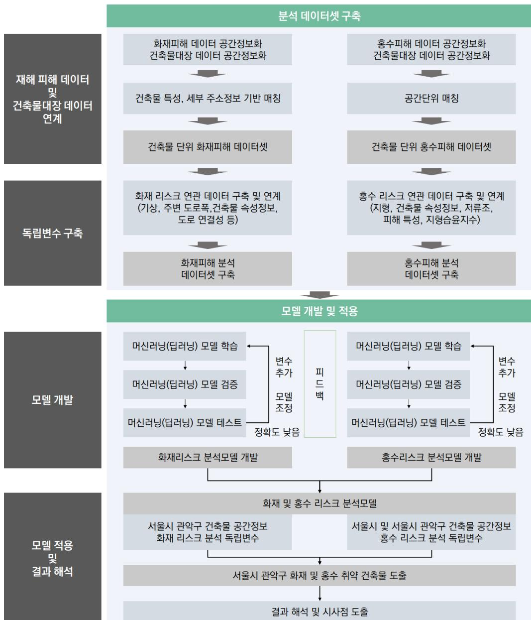
[그림 3-1] 건축물 화재 및 홍수 리스크 분석 모델 개발 프로세스
