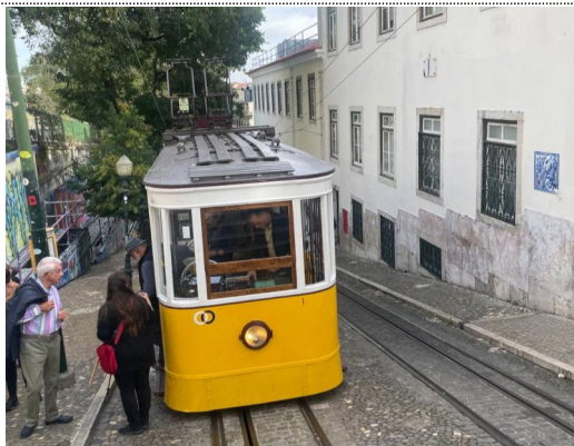
경사지에서 운행하는 교통수단으로 두 개의 레인을 통해 두 대의 푸니쿨라를 운영하고 있으며, 도르레 원리를 적용하여 상행과 하행으로 이동함
