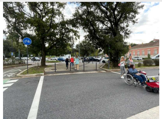
보도와 차도 간의 경계부 경사를 완만하게 조성하고, 보행섬의 진/출입 면을 평탄하게 조성해 휠체어를 이용하는 보행자의 이동 편의성을 높임
